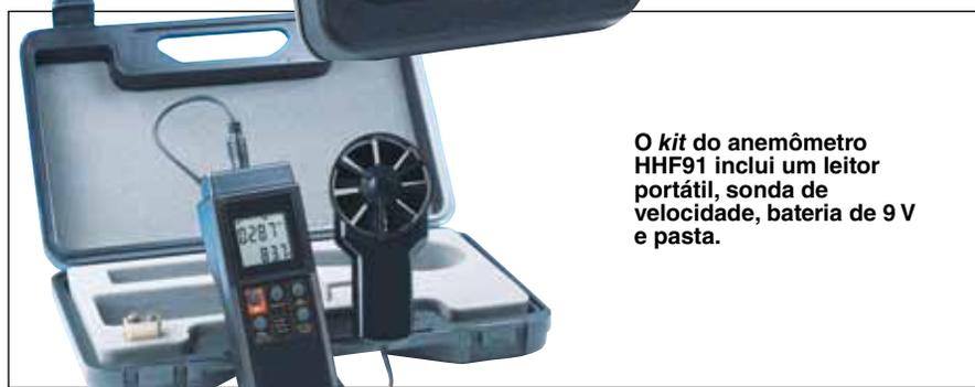
O kit do anemômetro HHF91 inclui um leitor portátil, sonda de velocidade, bateria de 9 V e pasta.
