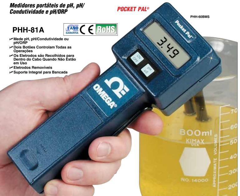
A série de instrumentos portáteis POCKET PAL é uma opção de medidores de pH, ORP e condutividade para aplicações laboratoriais e de campo. Os eletrodos são projetados para facilitar a substituição em campo e podem ser rapidamente calibrados por meio de potenciômetros de calibração de dois pontos de fácil acesso. Tela digital, invólucros resistentes de plástico ABS e sondas retráteis para proporcionar proteção tornam a série POCKET PAL ideal em termos de portabilidade e confiabilidade.
