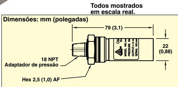
Barômetros eletrônicos OMEGA, série PX409, são barômetros de alta exatidão disponíveis em três intervalos: de 16 a 32 pol. Hg, de 26 a 32 pol. Hg ou de 0 a 32 pol. Hg (pressão absoluta) para aplicações de testes em laboratório ou indústrias. Os modelos com cabos integrais
