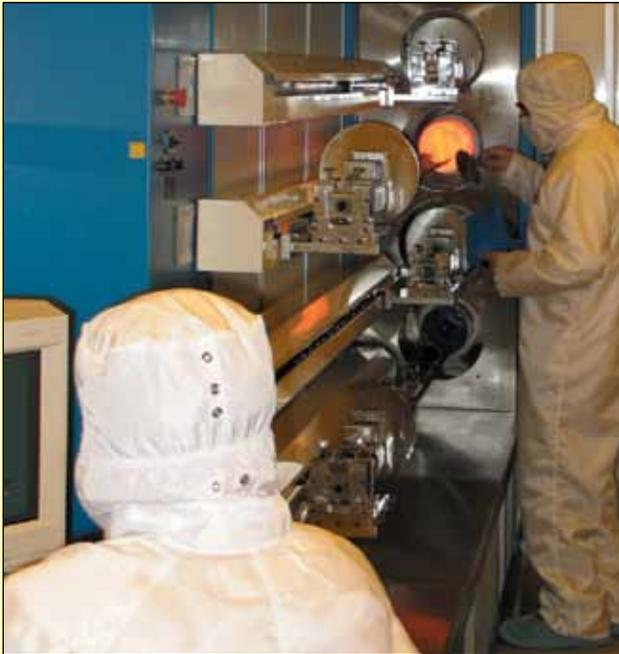
Os produtos da OMEGA fazendo produtos da OMEGA. A OMEGA utiliza as sondas de termopar Super OMEGACLAD™ XL em suas câmaras assépticas de classe 10 para monitorar as temperaturas críticas do processo e obter produtos consistentes e de alta qualidade.
