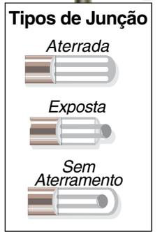
[\*]Especifique o tipo de junção: "**G**" (Aterrada), "**E**" (Exposta), "**U**" (Sem aterramento) ou "**S**" (Surface). [\*\*] Specify length in inches: **6, 12, 18** ou **24**.
