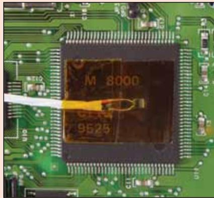
O sensor autoadesivo é ideal para a aplicação precisa em superfícies planas ou curvas. Uma vez no lugar, pode ser usada "como está" para medir temperaturas em aplicações, tais como ferramentas de máquinas, produtos eletrônicos, estruturas ou outros lugares onde a temperatura precisa ser monitorada e controlada.
