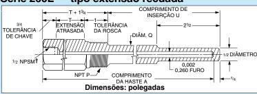
† A rosca interna do tubo NPSM se adapta tanto às roscas macho NPT como NPS.
